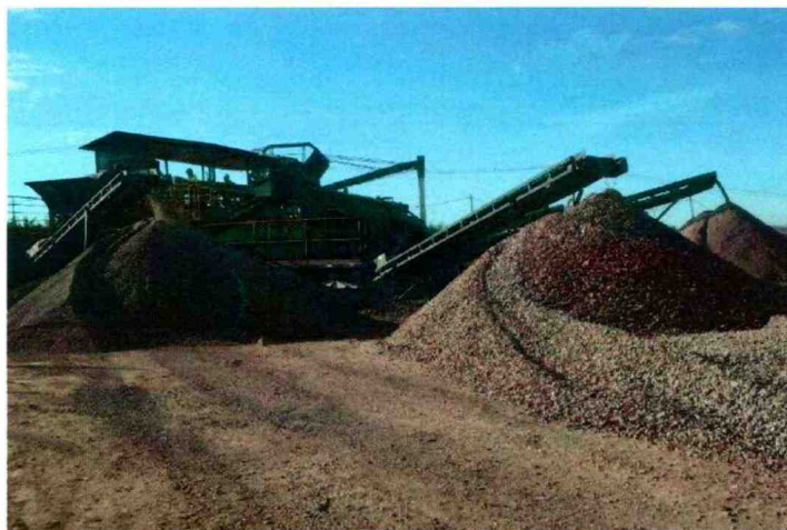
Figura 41- Material Agregado Reciclado. Fonte CSO Ambiental, 2019
